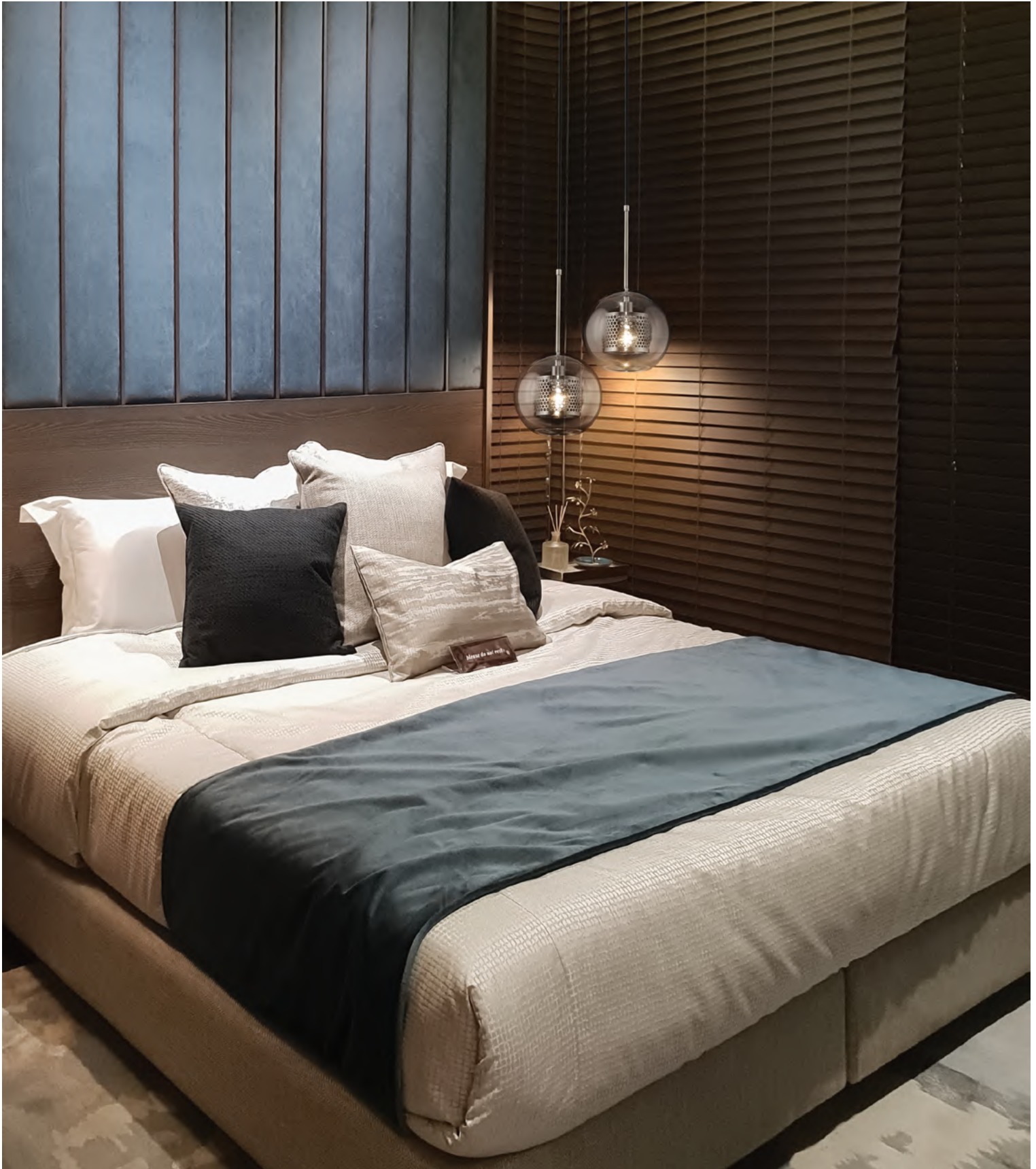
Металлическая арматура в двух оттенках: латунь, никель. Оригинальный двойной плафон. Внутренняя часть – ажурный металл в тон арматуре. Внешняя – прозрачное стекло. Источник света – лампа с цоколем E14.
