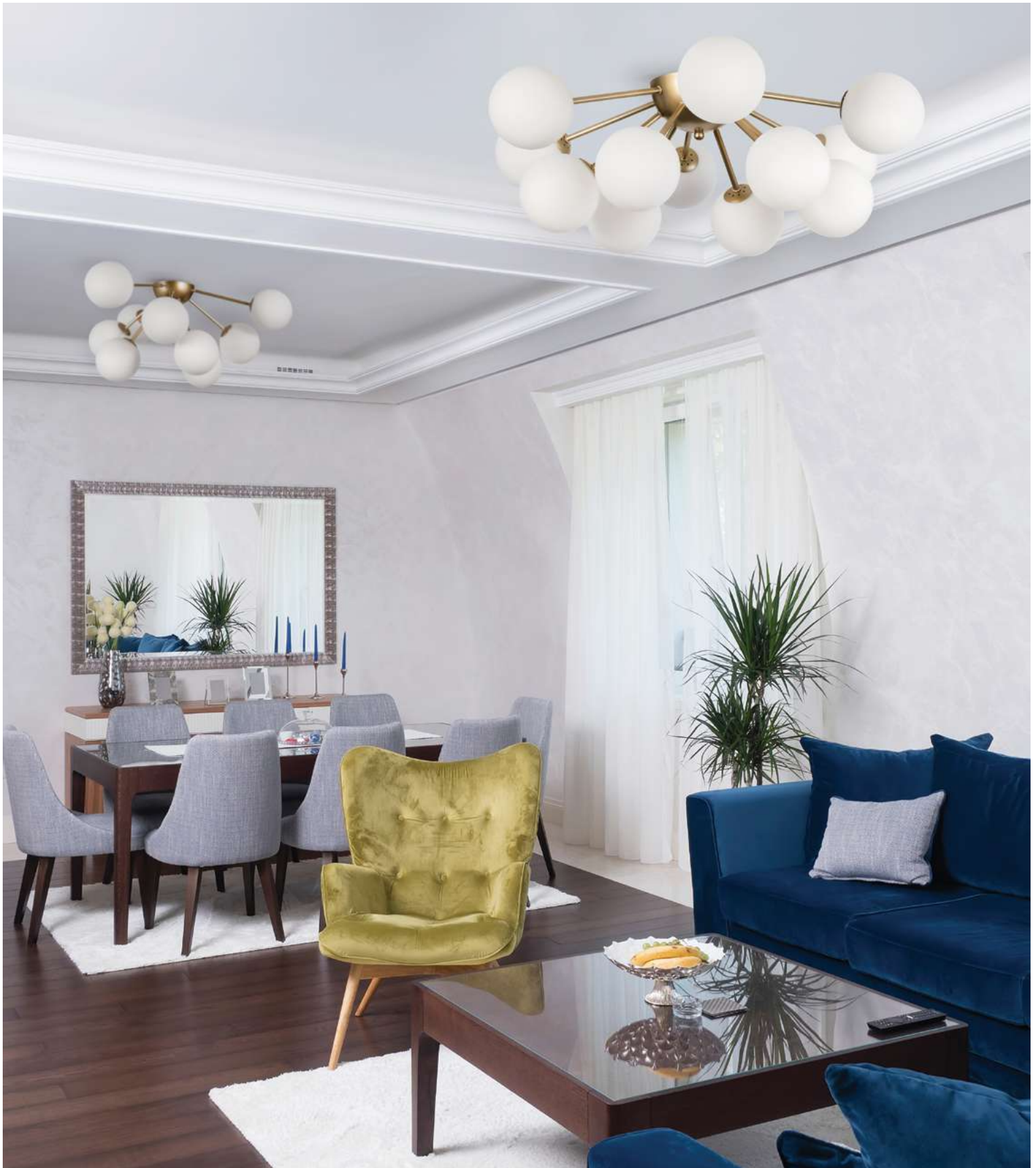
Арматура из металла. Цвет — матовое золото. Стекланные плафоны окрашены в матовый белый оттенок. Разнообразие конструктивных решений: асимметричная арматура, дугообразные рожки-лучи. Источник света — лампа с цоколем G9.
