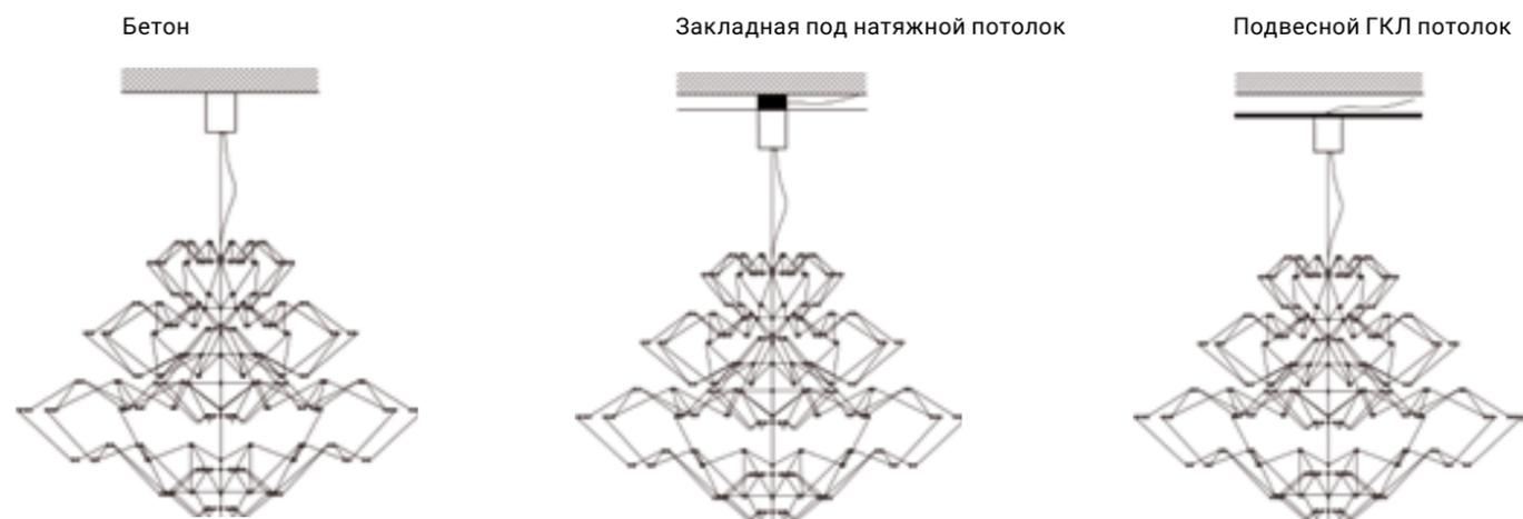
**Ориентация тросов, расположение бокса и питающего провода относительно тела светильника.**
